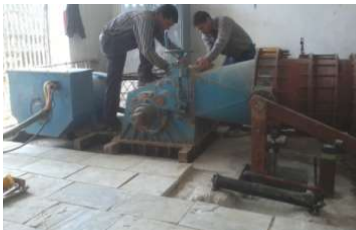
चित्र नं. ४.४५ : पानी चुहिन सक्ने उपकरणको वरिपरि होचो भाग
